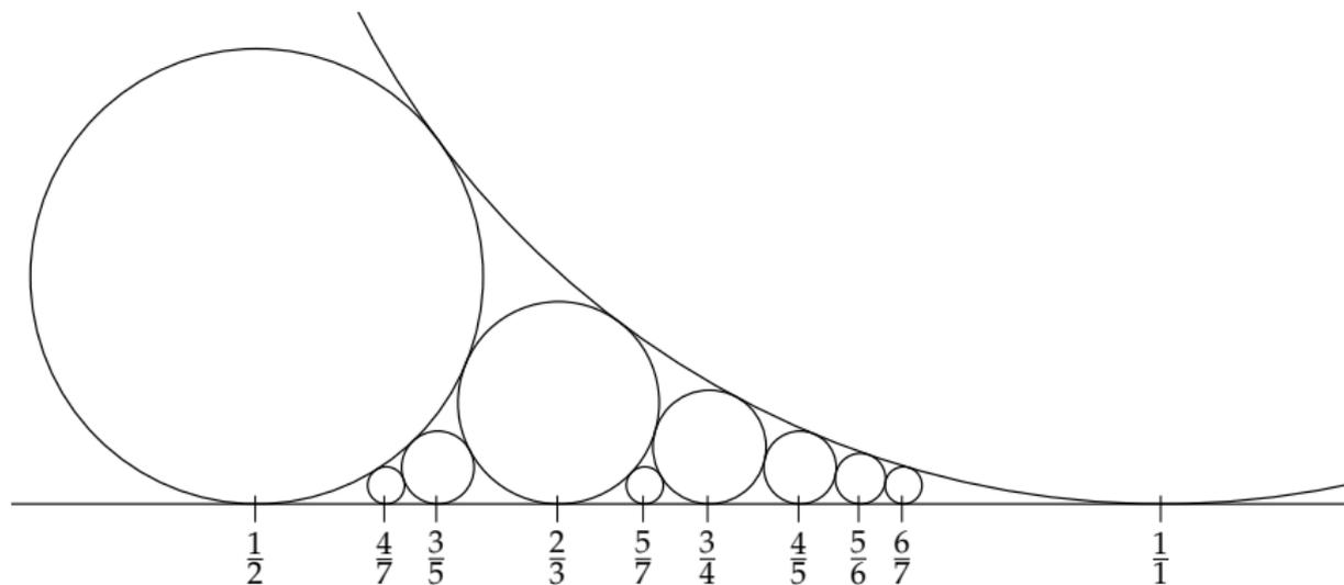
Zu einer rationalen Zahl  $a/b$  sei der Fordkreis  $K(a/b)$  der Kreis der Ebene mit dem Mittelpunkt  $(a/b, 1/(2b^2))$  und dem Radius  $1/(2b^2)$
