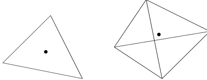
**Fig. B.2** The finite element  $P_0(K)$ .
