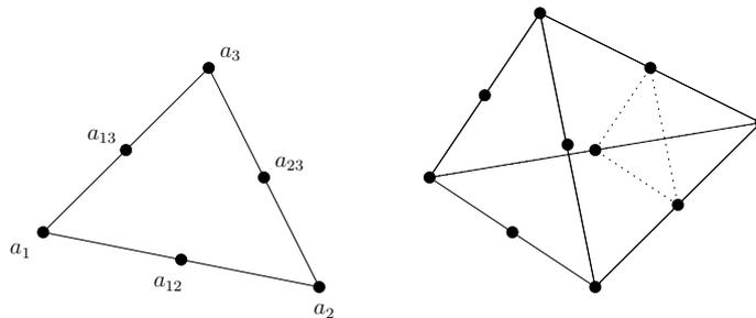
**Fig. B.4** The finite element  $P_2(K)$ .
