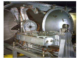
Fig. 3: EUV reflectometer (PTB WG 7.12)
