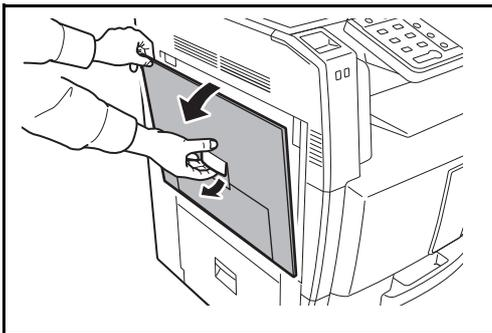
**3** Ziehen Sie den Hebel der linken Abdeckung und öffnen Sie die Abdeckung 1.
