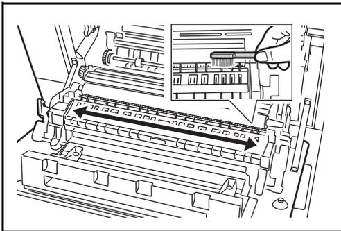
**4** Wie in der Abbildung gezeigt den Schmutz vom Separator reinigen, indem die Bürste entlang des Separators von einer Seite zur anderen bewegt wird.
