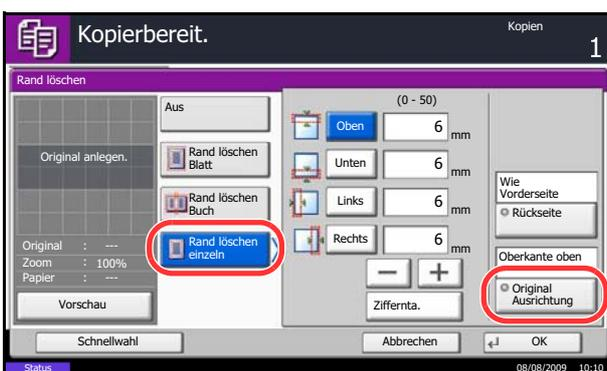
Tippen Sie auf [Original Ausrichtung], um die Ausrichtung der Originale als [Oberkante oben] oder [Oberkante links] auszuwählen. Tippen Sie auf [OK].
