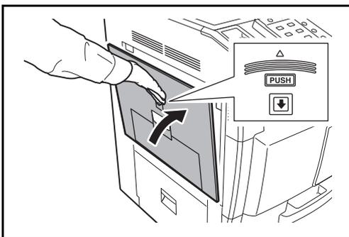
**5** Reinigungsbürste verstauen und die vordere Abdeckung sowie die linke Abdeckung 1 schließen.
