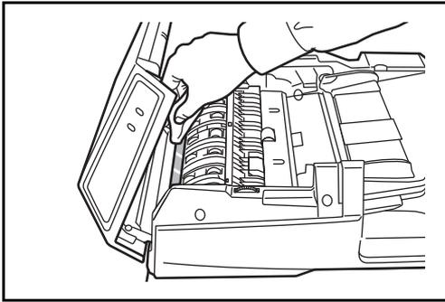
5 Das Belichtungsglas reinigen.
