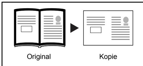
Damit werden schwarze Ränder an den Kanten und in der Mitte gelöscht. Sie können die Breiten einzeln eingeben, um die Ränder an den Kanten und in der Mitte des Buchs zu löschen.
