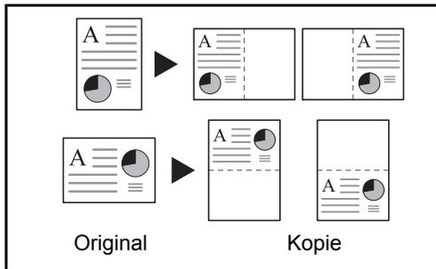
Reduziert Bilder jeder Originalseite für den Ausdruck auf einer Halbseite und lässt den Rest leer für Notizen.
