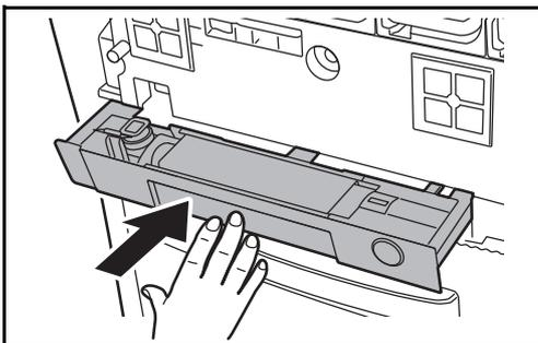
8 Drücken Sie von vorne auf den Resttonerbehälter, um das Resttoner-Fach zu schließen. Sobald sich das Fach in der korrekten Position befindet, hören Sie das Fach einrasten.
