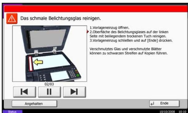
Wenn die Kopien bei der Verwendung des optionalen automatischen Vorlageneinzugs schwarze Streifen oder Schmutz aufweisen, reinigen Sie das Belichtungsglas mit dem im Lieferumfang enthaltenen Reinigungstuch. Die Meldung *Das Belichtungsglas reinigen* kann angezeigt werden, wenn das Belichtungsglas gereinigt werden muss.
