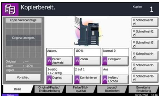
Nachstehend sehen Sie ein Beispiel, wie die Registrierung von *Helligkeit* mit *Originalvorlage* in der *Basis-Anzeige* für Kopiervorgänge ersetzt wird.
