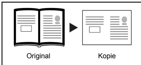
Damit werden schwarze Ränder an den Kanten und in der Mitte gelöscht. Sie können die Breiten einzeln eingeben, um die Ränder an den Kanten und in der Mitte des Buchs zu löschen.
