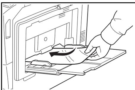
**WICHTIG:** Fächern Sie die Folien vorher sorgfältig auf. Maximal 10 Folien können eingelegt werden. Stellen Sie sicher, dass Papier und Folien die gleiche Ausrichtung haben.
