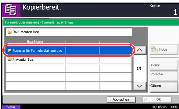
Um bereits gespeicherte Formulare zu verwenden, tippen Sie auf [Auswählen Gesp. Formular]. Tippen Sie auf [Formular auswählen], um die Dokumentenboxen zu zeigen, die Dokumente enthalten, die für ein Formular verwendet werden können. Wählen Sie das gewünschte Formular aus der Liste und tippen Sie auf [OK].
