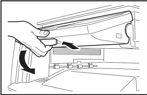
Sie können den Neigungswinkel des Bedienfeldes einstellen, indem Sie am Hebel auf der Unterseite des Bedienfeldes ziehen.
