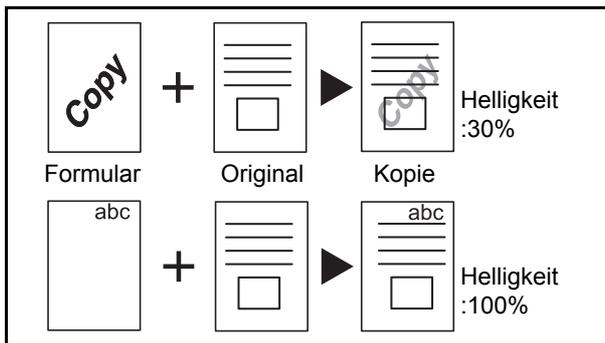
Kopiert das Original auf einen zu wählenden Hintergrund, genannt das Formular. Nachdem Sie das Formular eingescannt und gespeichert haben, wird das Formular über das Original kopiert. Sie können auch ein Formular verwenden, das sich bereits im Speicher des Geräts gespeichert ist.
