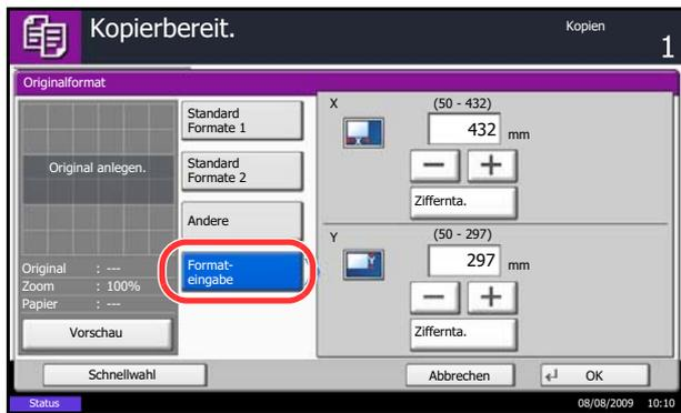
Wenn [Formateingabe] ausgewählt ist, tippen Sie auf [+] oder [-], um die horizontale (X) und vertikale (Y) Dimension einzugeben. Tippen Sie auf [Ziffernta.], um das Format direkt über die Zifferntasten einzugeben.
