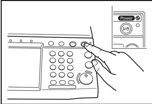
Um den Ruhemodus zu aktivieren, drücken Sie die Taste **Power**. Die Anzeige und alle Leuchten auf dem Bedienfeld erlöschen und nur noch die Netzanzeige leuchtet, um maximalen Strom zu sparen. Dieser Status wird als Ruhemodus bezeichnet.
