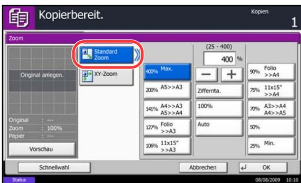
Tippen Sie auf [+] und [-], um die angezeigte Größenänderung zu ändern. Sie können die Vergrößerung auch direkt über die Zifferntasten eingeben, indem Sie auf [Ziffernta.] tippen.
