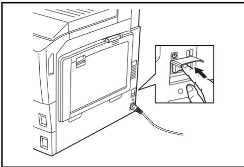
Öffnen Sie die Abdeckung des Hauptschalters und schalten Sie den Hauptschalter ein.
