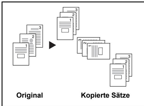
Falls kein optionaler Finisher installiert ist, wird bei der Einstellung "Versetzt" jeder Kopiersatz um 90° gedreht ausgegeben.
