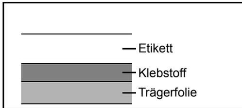
Etiketten bestehen wie in der Abbildung zu sehen aus drei verschiedenen Lagen. Der Klebstoff stellt für das Gerät das größte Risiko da, denn er wird Druck und Wärme ausgesetzt. Die Trägerfolie trägt das Etikett beim Transport durch das Gerät. Die Kombination der verschiedenen Materialien kann Probleme verursachen.
