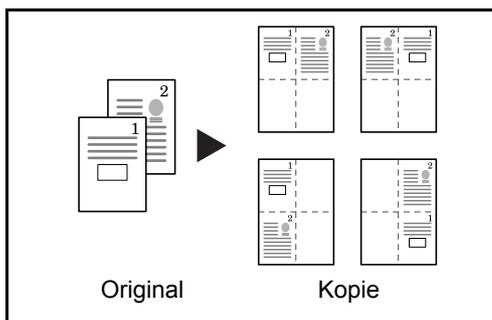
Reduziert Bilder von zwei Originalseiten für den Ausdruck auf einer Halbseite und lässt den Rest leer für Notizen.
