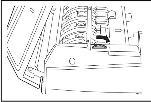
Wenn das Original nicht leicht entfernt werden kann, drehen Sie das Antriebsrad des Einzugs. Das Original wird in eine Position transportiert, die Ihnen das leichte Entnehmen ermöglicht.
