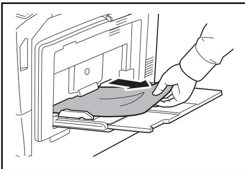
**1** Entfernen Sie sämtliches Papier aus der Universalzufuhr.
