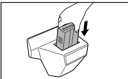
Setzen Sie den Schlüsselzähler fest in den Zählersteckplatz ein.
